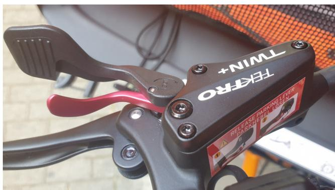
**b) Lösen:** Zunächst muss der rote Hebel gegen den schwarzen gedrückt werden. Dann können beide Hebel (schwarz und rot) zusammen nach vorne in die Ruhelage gezogen werden. Die Bremse wird dadurch gelöst.
